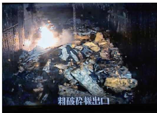
↑破砕機で発火した様子
