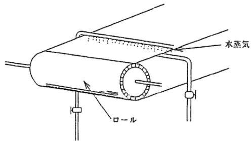
(蒸気噴射法の例)
