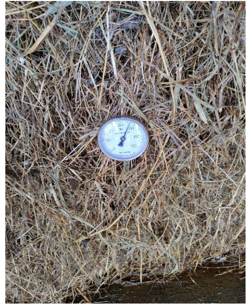
【図 1 2】とうふと副資材を混ぜて堆積すると、一日で温度は 80℃くらいにまで上昇する
