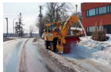
拡幅除雪 (ロータリ除雪車)
