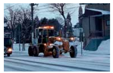
新雪除雪（除雪グレーダ）
